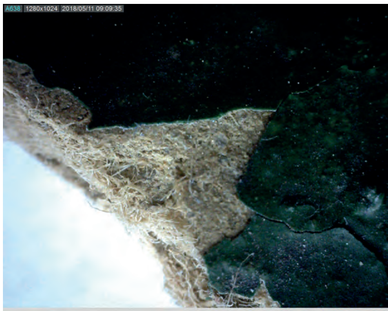
8 pav. Molio masės mėginio nuotrauka, kurioje matomi pridėti augalinės kilmės plaušai. Fotografuota skaitmeniniu mikroskopu CVJM–K149.
